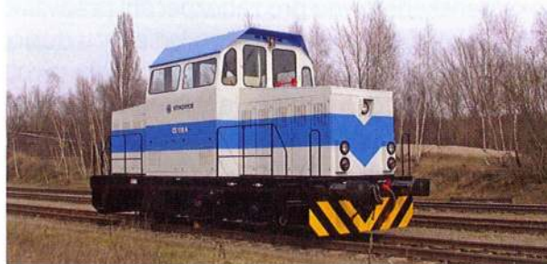
KT 110A je trojosý kolejový tahač s akumulátorovým pohonem KT 110A is three-axle locotractor with accumulator drive
